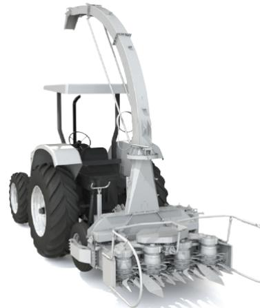
Moderno sistema de terceiro ponto da máquina que possibilita trabalho em ré para abertura do carreador e facilidade de transporte.
